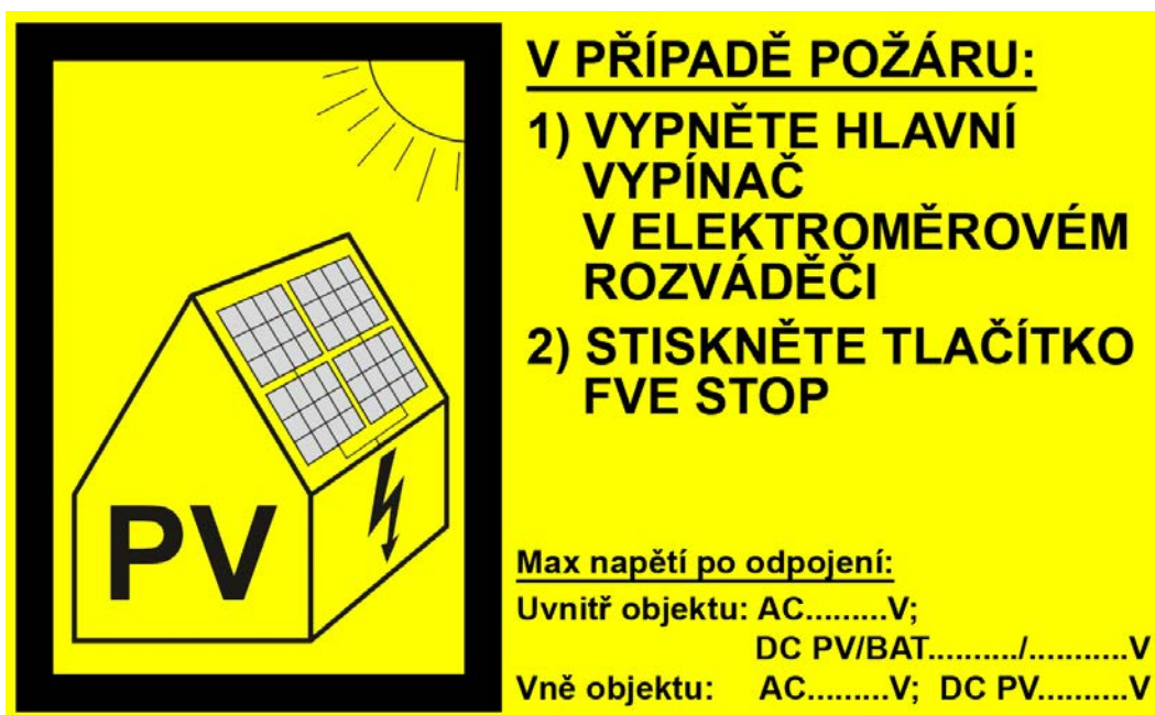
Obr. 15 Výstražná samolepka umístěná v elektroměrovém rozváděči a na hlavním rozváděči FVE
